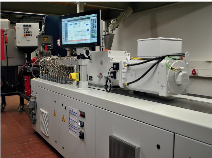
Anlagenaufbau zur Untersuchung des Materialabbaus inklusive des Doppelschneckenextruders ZE28 BluePower von KraussMaffei © KTP
